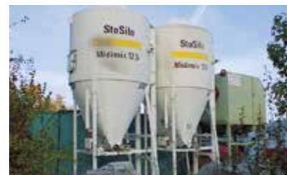
StoSilo Midimix 12.5 - 18 tonna befogadóképességgel
